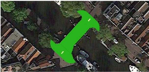
Figuur 3: voorbeeld in de binnenstad van Amsterdam waar 2 stacks TerraSAR-X gebruikt zijn voor een horizontale decompositie.
