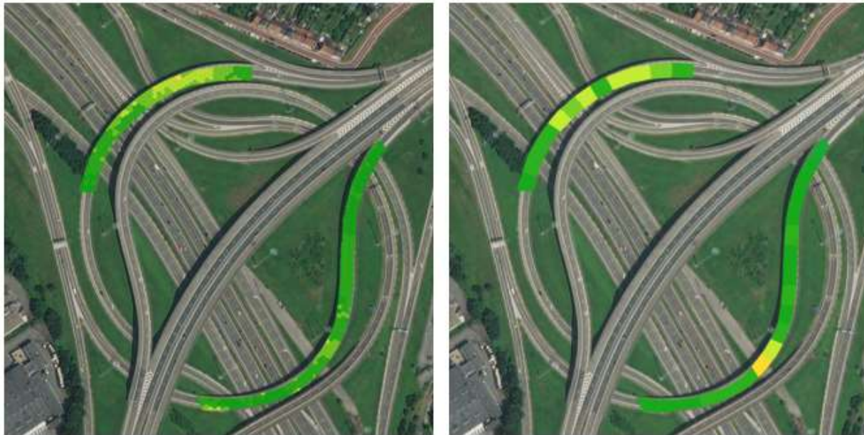
Figuur 7: Links een kunstwerk gemeten met TerraSAR-X, rechts met Sentinel-1. Deze productlagen zijn dynamisch en worden o.b.v. de beschikbare resolutie gesegmenteerd.
