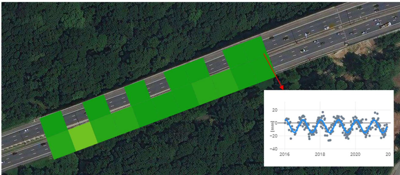
Figuur 10: De westkant van het Viaduct van Vilvorde met Sentinel-1. Duidelijk zichtbaar dat er meer Sentinel-1 metingen beschikbaar zijn, maar nog het viaduct niet volledig dekken. Wel duidelijk zichtbaar is dat Sentinel-1 de seizoensbeweging beter in kaart kan brengen.
