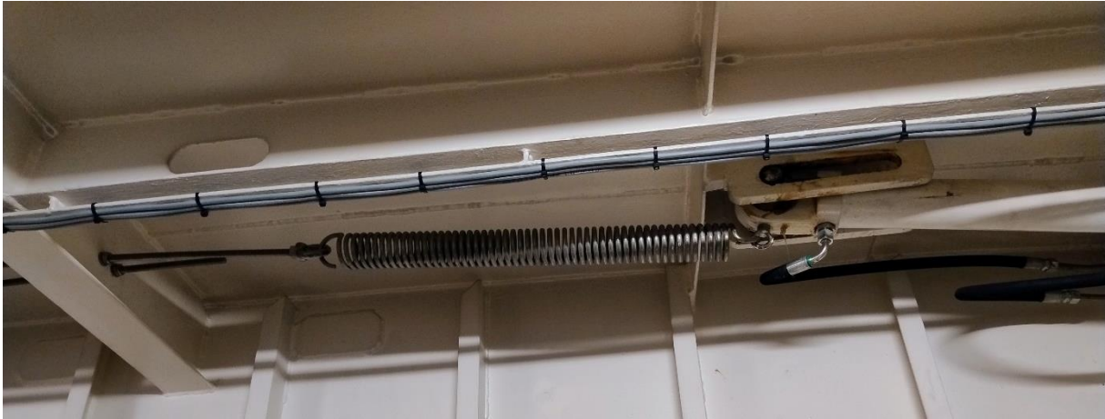
Figuur 32: Actuator brug RR - veer
